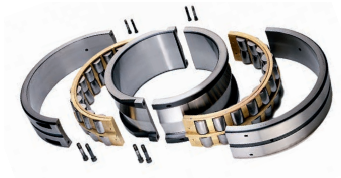
Roulements à rotule sur rouleaux FAG en deux parties avec cage massive en deux parties en polyamide renforcé avec des fibres de verre ou en laiton ; anneaux de serrage intégrés
