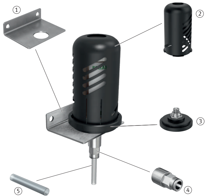
1 固定支架 2 保护盖 3 安装支架 4 带内螺纹的软管接头零件 5 软管
