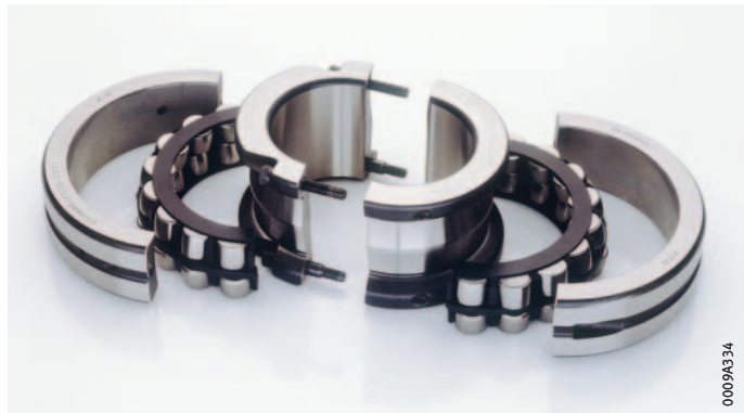
Bild 9 Geteiltes Pendelrollenlager mit geteiltem Massivkäfig aus glasfaserverstärktem Polyamid oder aus Messing, Spannringe integriert
