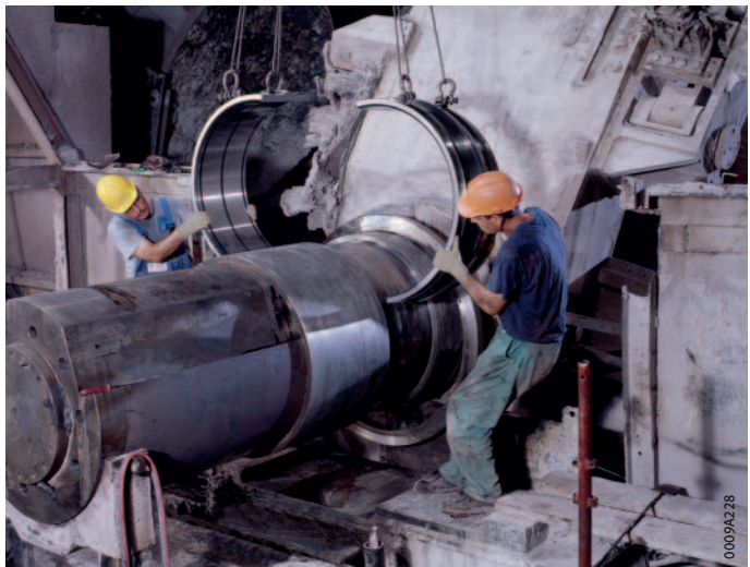
Bild 7 Montage eines großen geteilten Pendelrollenlagers
