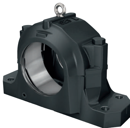
2 Geteilte Stehlagergehäuse SES, Sonderausführung mit 4 Bohrungen für Fußschrauben
