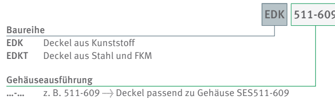
21 Aufbau der Kurzzeichen von Deckeln, Beispiele
