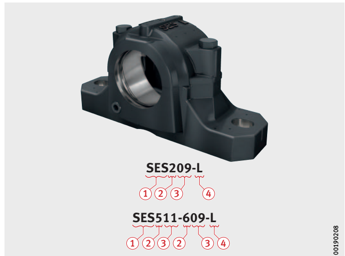
Bild 7 Aufbau der Kurzzeichen von Stehlagergehäusen SES, Beispiele
