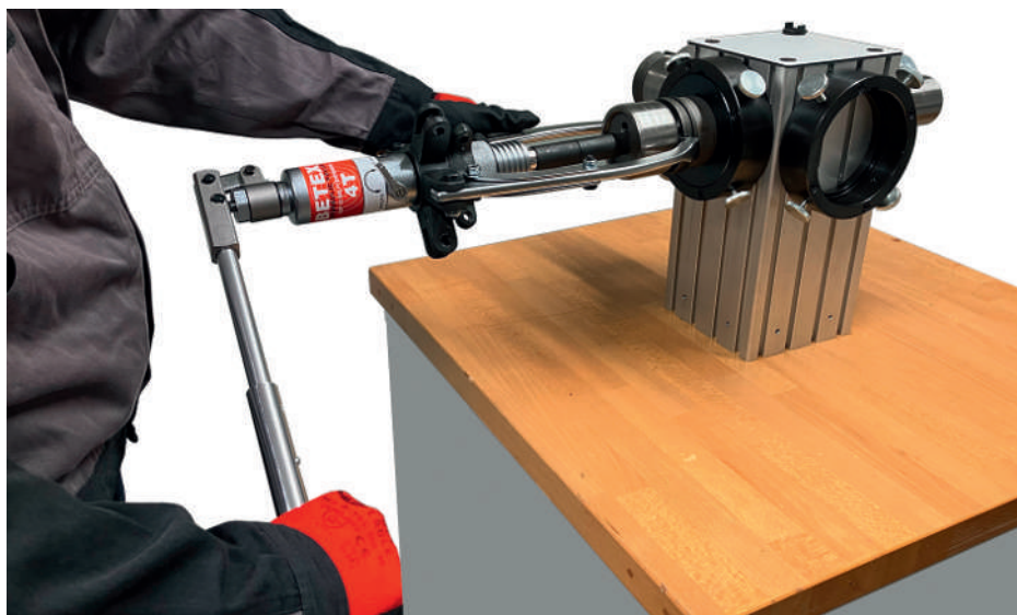
14 Applicazione dell'estrattore idraulico HSP
