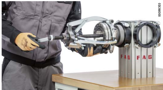
Figure 2 Utilisation des plaques de démontage en trois parties PULLER-TRISECTION
