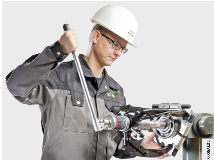
Figure 1 Utilisation de l'extracteur hydraulique PULLER-HYD en combinaison avec les plaques de démontage en trois parties PULLER-TRISECTION
