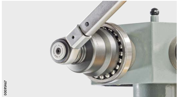
Figure 2 Utilisation de l'adaptateur LOCKNUT-SOCKET
