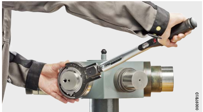
Figure 3 Utilisation de la clé à double ergot LOCKNUT-DOUBLEHOOK
