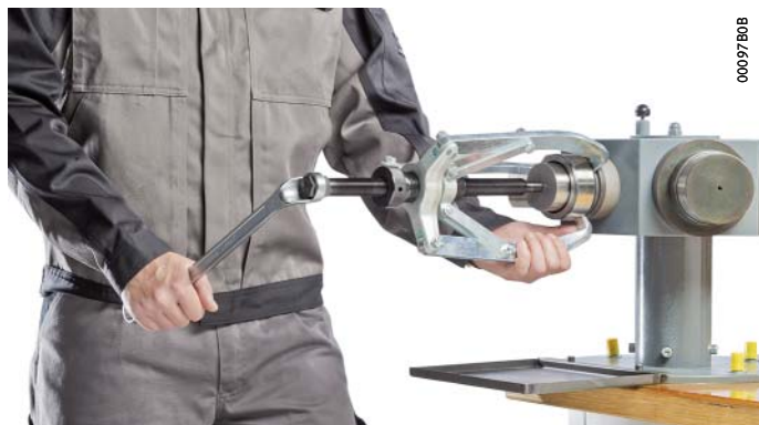
Figure 2 Utilisation de l'extracteur à trois bras PULLER-3ARM
