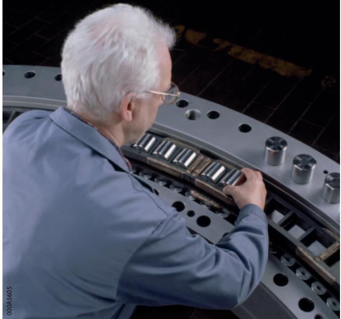
Bild 1 Aufbereitung Wälzlager für eine Tunnelbohrmaschine, Montage der Wälzkörper
