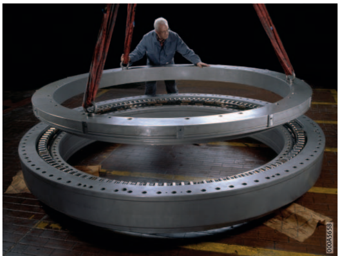
Bild 9 Montage eines neuen Wälzlagerrings
