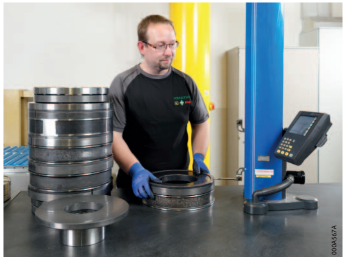
Bild 3 Tandemlager wird vermessen
