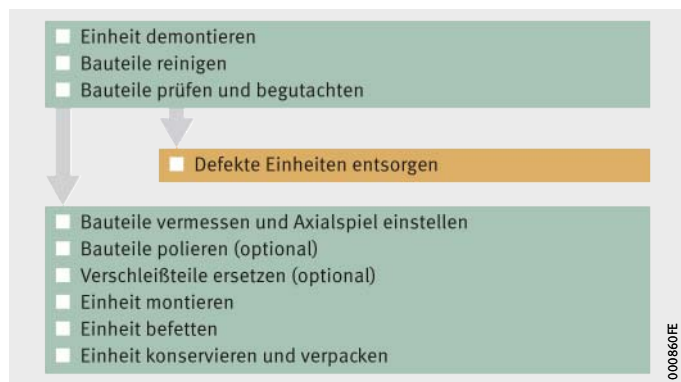
Bild 20 Aufbereitung TAROL-Einheiten
