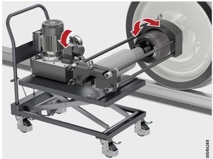
Bild 6 Abziehschuh liegt auf Welle
