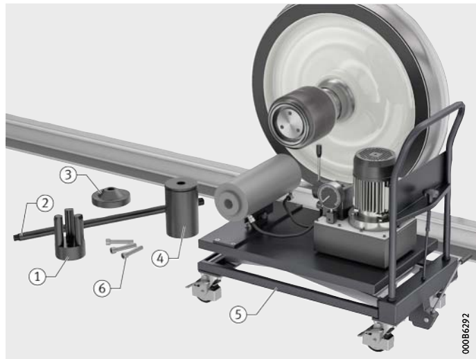
Bild 1 Fahrbare Hydraulikvorrichtung mit Komponenten für Montage
