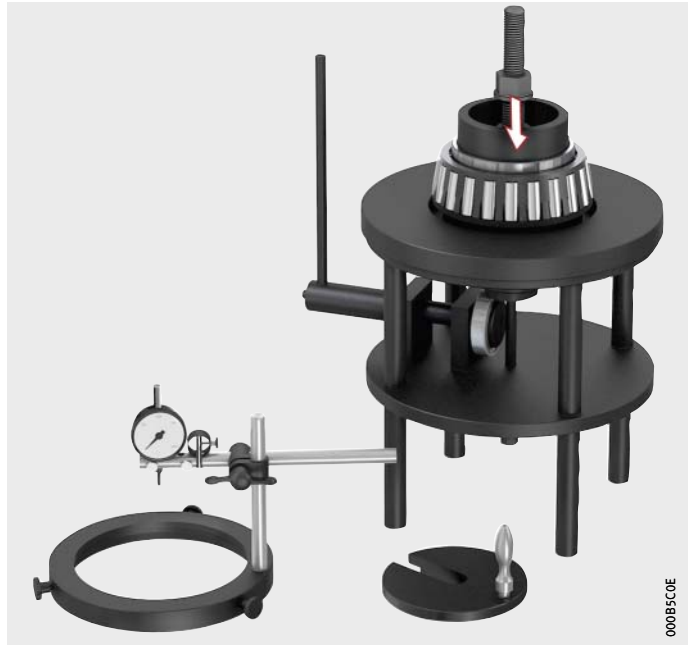
Bild 8 Innenring auf Zentrierbuchse aufschieben
