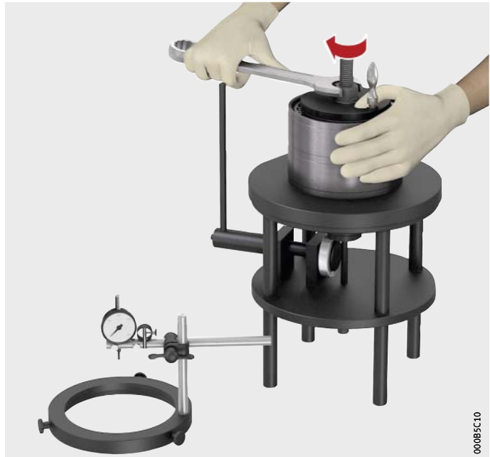
Bild 9 Mutter mit Schlüssel anziehen
