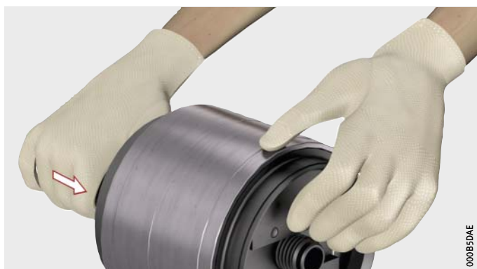
Bild 11 Stempel durch die Lagerbohrung führen
