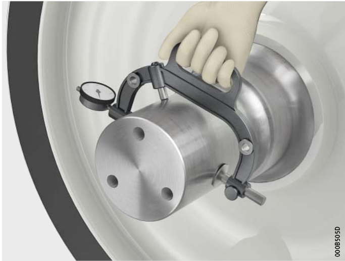
Bild 11 Wellenschenkel mit Bügelmessgerät messen
