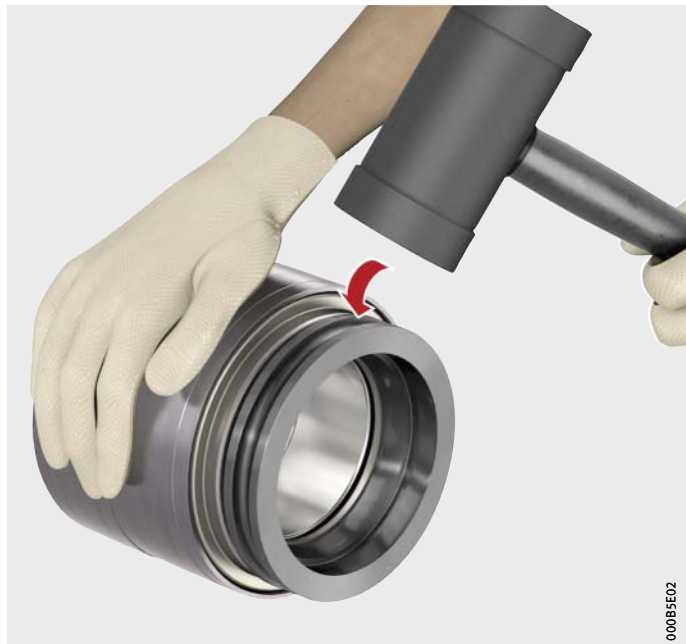
Bild 16 Stützring bei TAROL-Variante mit Blechkappendichtung entfernen
