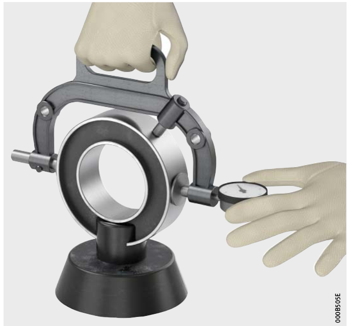
Bild 10 Einstellen des Bügelmessgeräts an der Maßscheibe
