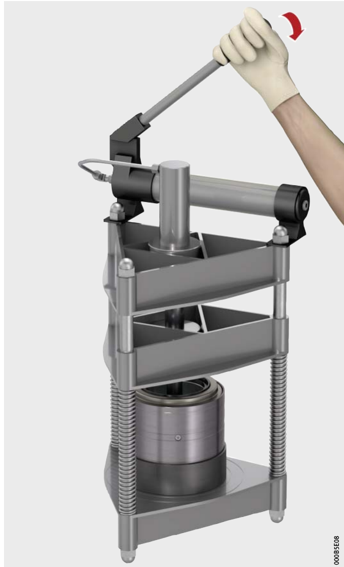
Bild 19 TAROL-Einheit in Plattenpresse setzen, ausrichten und Presse betätigen
