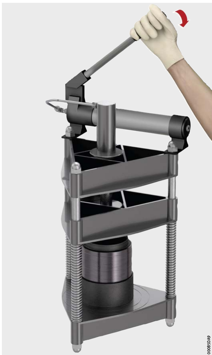
Bild 14 Lager in Presse setzen und ausrichten; Presse betätigen
