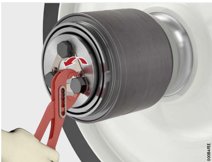
Bild 10 Lappen des Sicherungsblechs umbiegen
