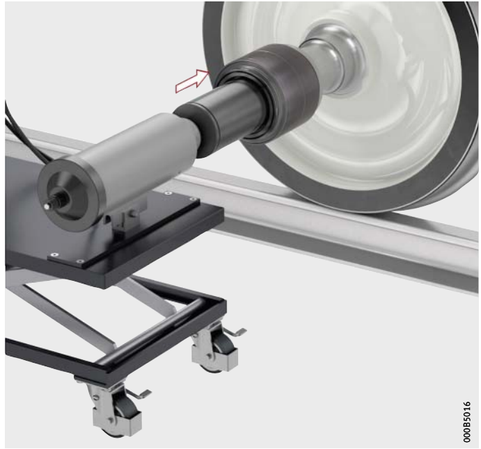
Bild 5 Hydraulikvorrichtung auf TAROL-Einheit ausrichten
