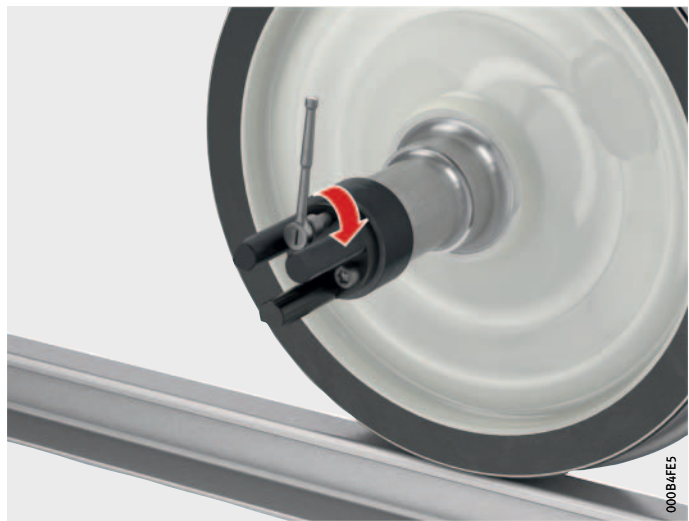
Bild 1 Führungsbuchse an Wellenschenkel anschrauben
