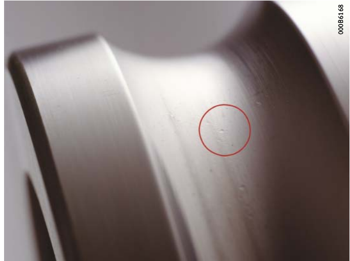
Bild 4 Laufbahneindrücke durch Verunreinigung
