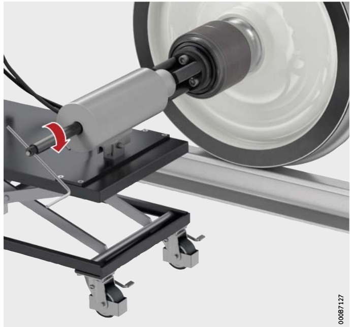
Bild 5 Spindel in Führungsbuchse einschrauben
