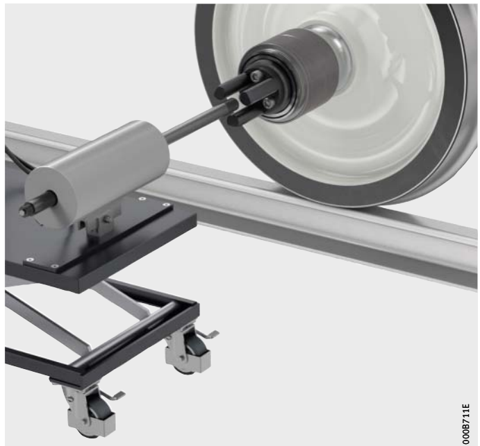
Bild 4 Spindel durch Hohlkolben stecken
