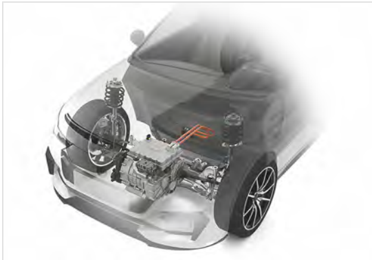
Bild 3 Das hochintegrierte und kompakte Gesamtsystem der 4in1-E-Achse benötigt deutlich weniger Bauraum als nicht integrierte Lösungen
