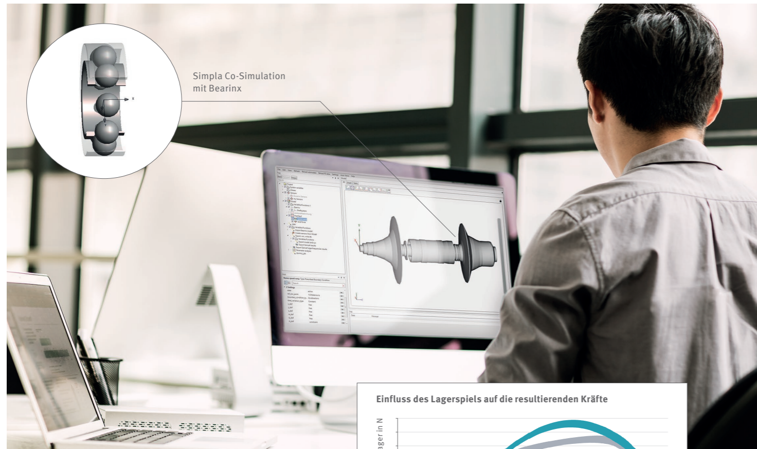
Rotordynamische Untersuchung eines Turboladers
