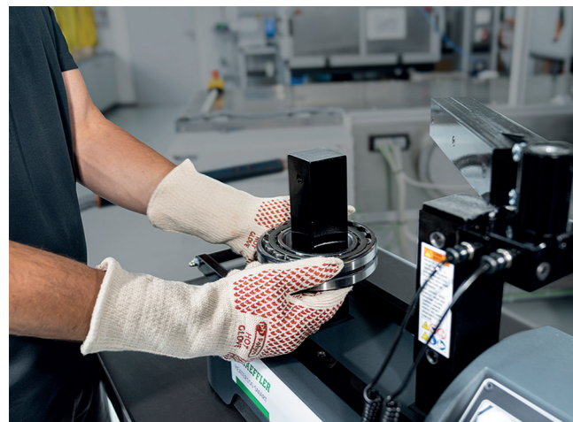
Outils industriels – Montage Industrie : Les dispositifs HEATER évitent, grâce au chauffage inductif, des dommages tels qu'un fonctionnement irrégulier, des cassures ou des marques d'abrasion.
