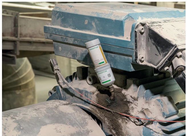
Schmierlösung Zement: OPTIME C1 schmiert punktgenau und gibt dank der smarten Technologie stets ortsunabhängig den Status auf einem (mobilen) Endgerät an
