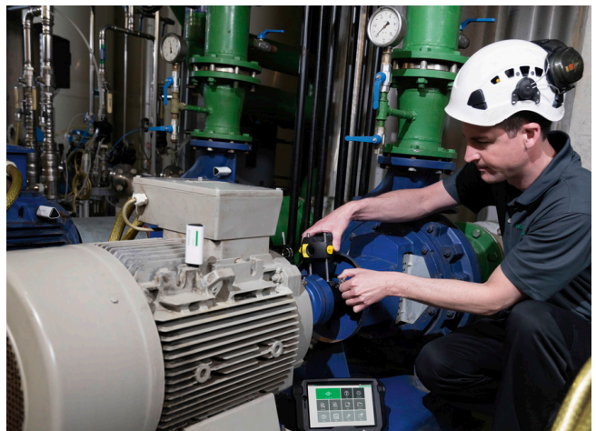
Industriewerkzeuge – Ausrichten Industrie: LASER-EQUILIGN2 sorgt dank der Singel-Laser-Technologie stets für eine fachgerechte Ausrichtung ihrer Maschinen
