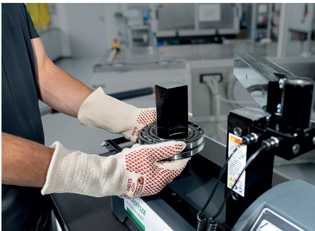
Industriewerkzeuge – Montage Industrie: HEATER verhindern durch die schonende Induktive Erwärmung Schäden wie zum Beispiel unruhiger Lauf, Brüche oder Schürfmärken
