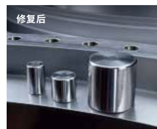
重新研磨的滚道,调整后尺寸加大的新滚动体
