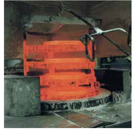
通过表面硬化处理提高耐磨性和抗疲劳强度
