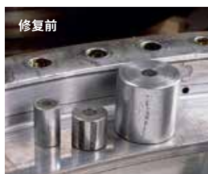
带有腐蚀痕迹和异物压痕的滚动体和滚道
