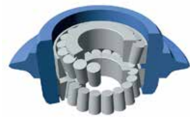
使用舍弗勒Bearinx计算软件计算边刀轴承
