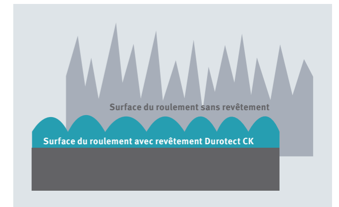
Question de structure : Les surfaces avec revêtement Durotect CK sont résistantes à l'usure et réduisent les frottements.
