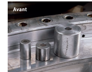
Rouleaux et piste de roulement avec traces de corrosion et empreintes de corps étrangers
