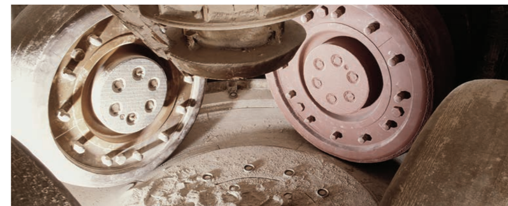
Galets de broyage d'un broyeur vertical (traitement du ciment)
