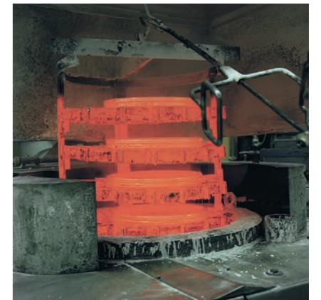
Augmentation de la résistance à l'usure et à la fatigue grâce à la cémentation
