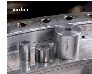
Vorher Rollen und Laufbahn mit Korrosionspuren und Fremdkörpereindrücken
