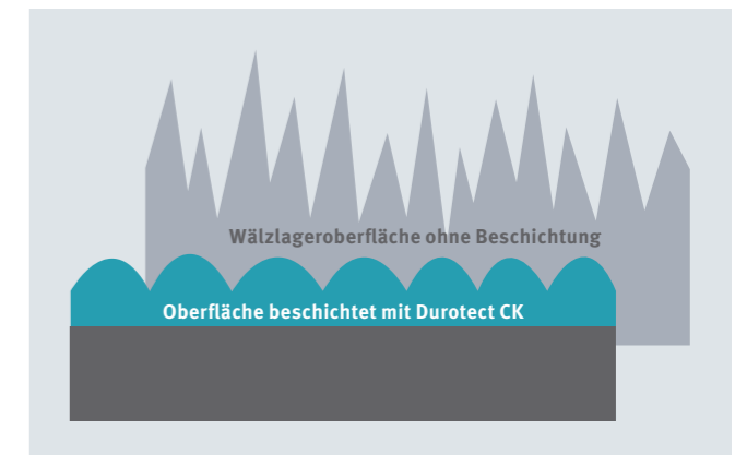
Strukturfrage: Mit Durotect CK beschichtete Oberflächen sind verschleißfester und wirken reibungssenkend
