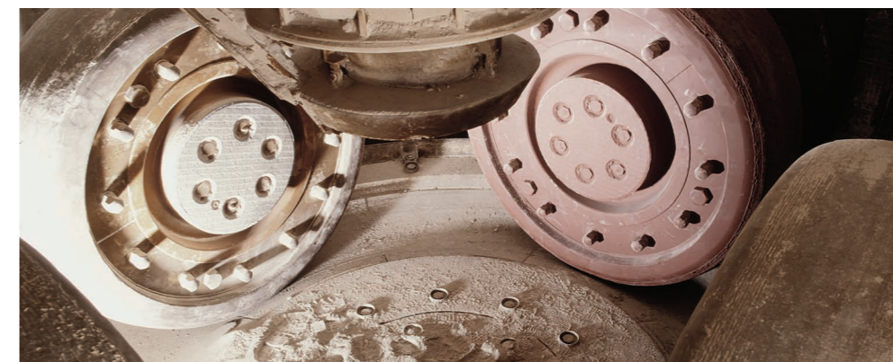
Mahlwalzen einer Vertikalmühle (Zementverarbeitung)
