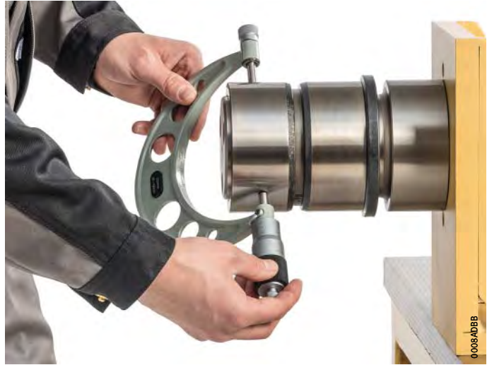
Figura 3 Medir la expansión mediante un micrómetro exterior
