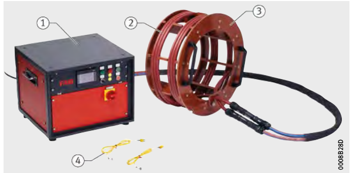
Figura 18 Dispositivo de calentamiento de media frecuencia FAG
