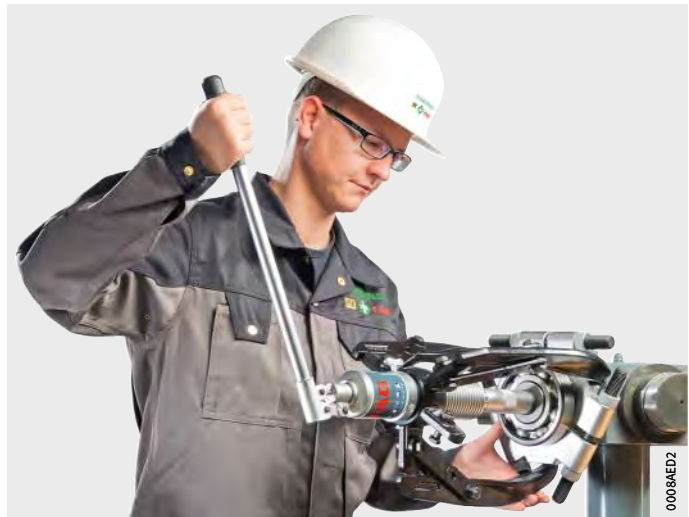
Figura 1 Desmontaje mediante dispositivos de extracción
