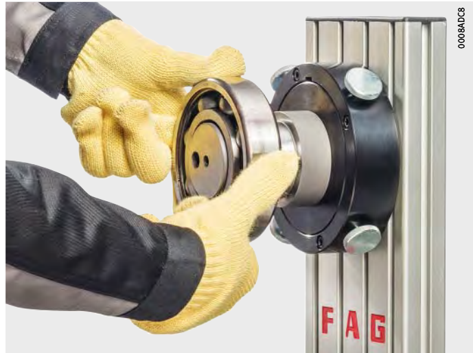
Bild 14 Aufziehen angewärmter Lagerteile
