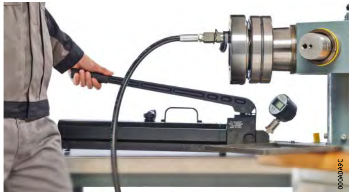
Bild 9 Hydraulische Demontage bei kegeligem Sitz
