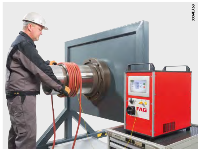
Bild 5 Demontage von Lagerinnenringen mit flexiblem Induktor
