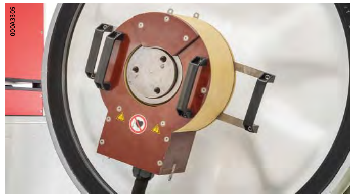
Bild 6 Demontage Lagerinnenringe von Radsatzlagern (Schienenfahrzeuge) mit Festinduktor
