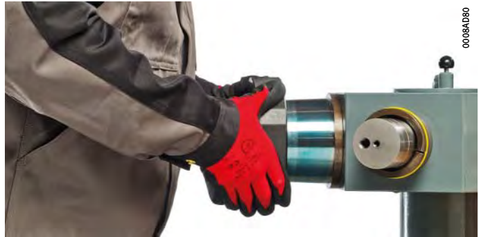
Bild 5 Touchieren mit einem Kegellehrring
