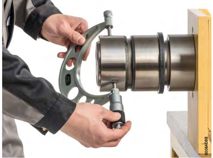
Bild 3 Aufweitung mit Außenmikrometer messen
