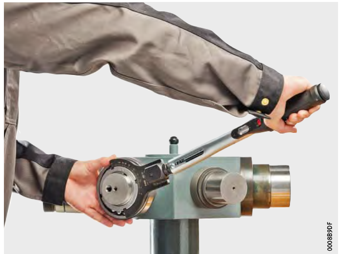
Bild 11 Montage mittels Doppelhakenschlüssel
