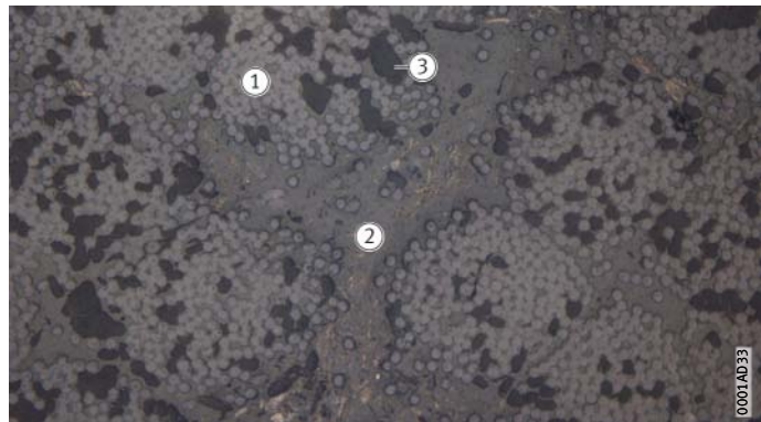
Bild 1 Mikroschliffbild der Gleitschicht einer ELGOTEX-WA-Wickelbuchse
