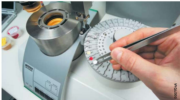
Bild 1 Analyse zum Temperaturverhalten von Fetten
