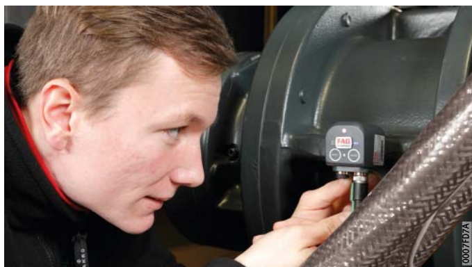
Bild 3 Inbetriebnahme eines FAG SmartCheck
