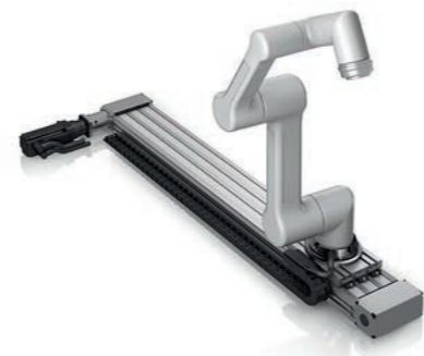
Configuré selon les souhaits du client: notre 7e axe
