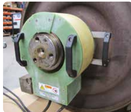
Nagrzewanie pierścieni łożysk do demontażu
