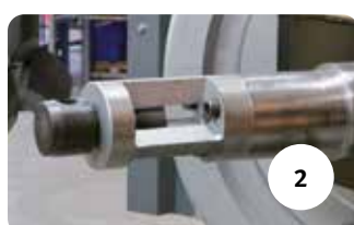
Stopniowy demontaż zespołów łożyskowych TBU / SP / TAROL
