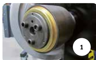
Stopniowy demontaż zespołów łożyskowych TBU / SP / TAROL
