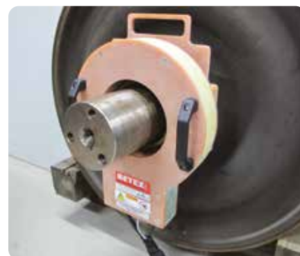
Chauffe de joints labyrinthes pour démontage
