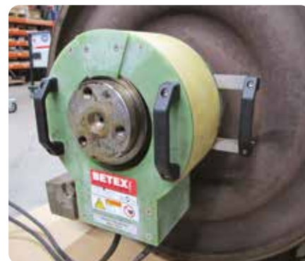
Chauffe de bagues de roulement pour démontage
