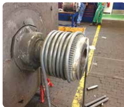
Chauffe d'un accouplement pour démontage
