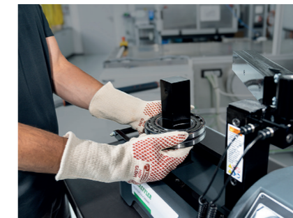
Industrie: HEATER verhindern durch die schonende induktive Erwärmung Schäden wie zum Beispiel unruhiger Lauf, Brüche oder Schürfmacken
