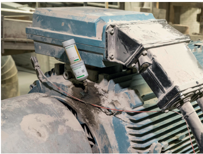
Zement: OPTIME C1 schmiert punktgenau und gibt dank der smarten Technologie stets ortsunabhängig den Status auf einem (mobilen) Endgerät an
