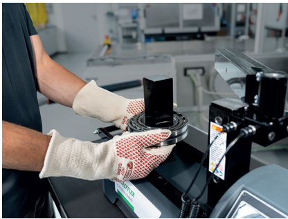
Industrie: HEATER verhindern durch die schonende induktive Erwärmung Schäden wie zum Beispiel unruhiger Lauf, Brüche oder Schürfmacken
