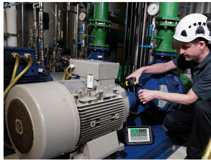
Industrie: LASER-EQUILIGN2 sorgt dank der Single-Laser-Technologie stets für eine fachgerechte Ausrichtung ihrer Maschinen
