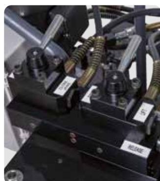
Bloque de válvulas
