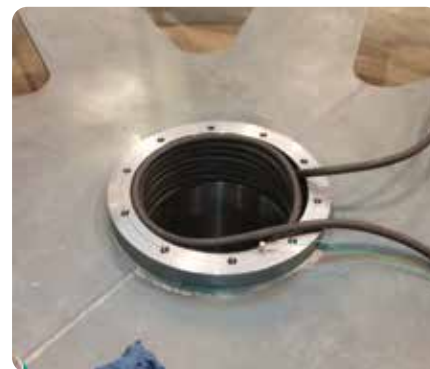
Calentamiento de un orificio para el montaje de un rodamiento o un eje
