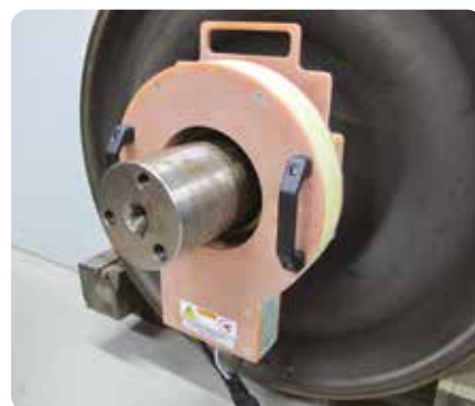
Calentamiento de anillos laberínticos para desmontaje
