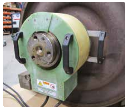
Calentamiento de anillos de rodamientos para desmontaje
