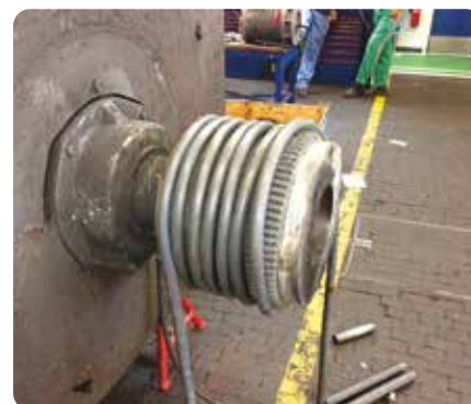
Calentamiento de un acoplamiento para desmontaje
