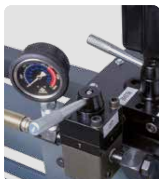
Bloque de válvulas
