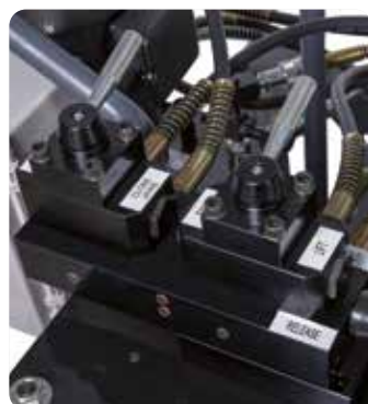
Bloque de válvulas
