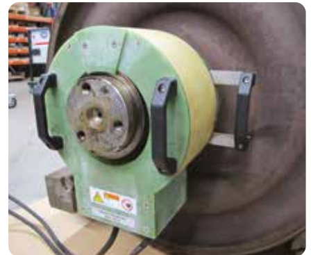
Verwarming van lagerringen voor demontage
