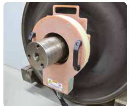
Verwarming van labyrintingen voor demontage
