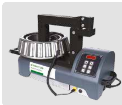
Horizontale Erwärmung empfohlen
