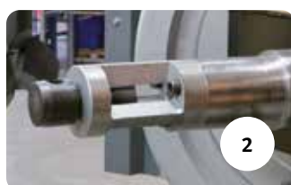
Montage von TBU / SP / Tarol-Lagersätzen in Einzelschritten
