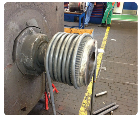
Erwärmung einer Kupplung zur Demontage
