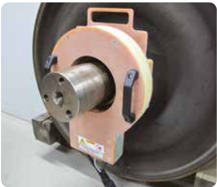
Erwärmung eines Labyrinthrings zur Demontage
