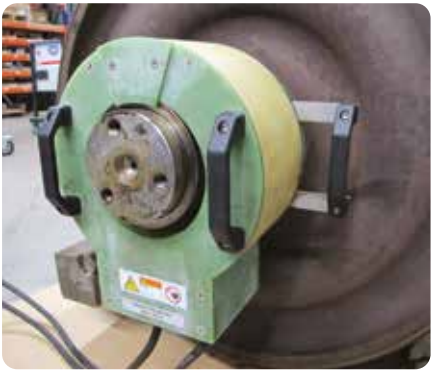
Erwärmung eines Lagerrings zur Demontage
