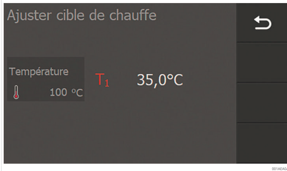
35 Exemple de cible de chauffage
