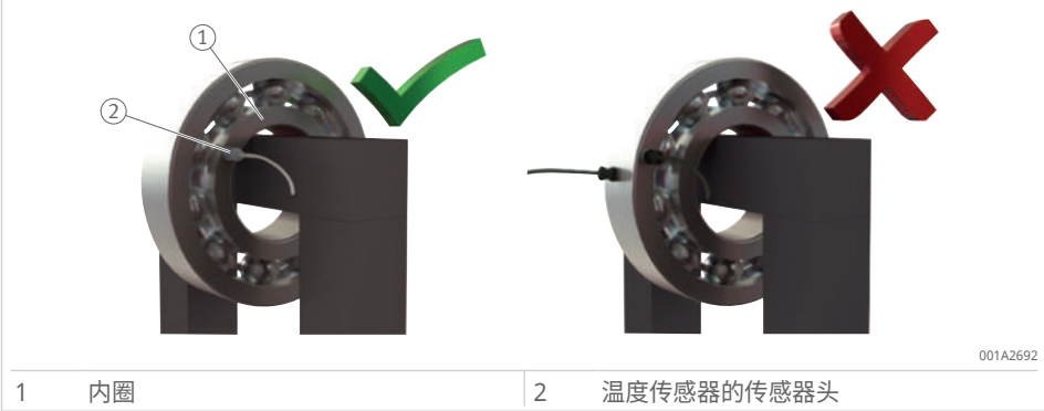
图 43 连接温度传感器 T1
