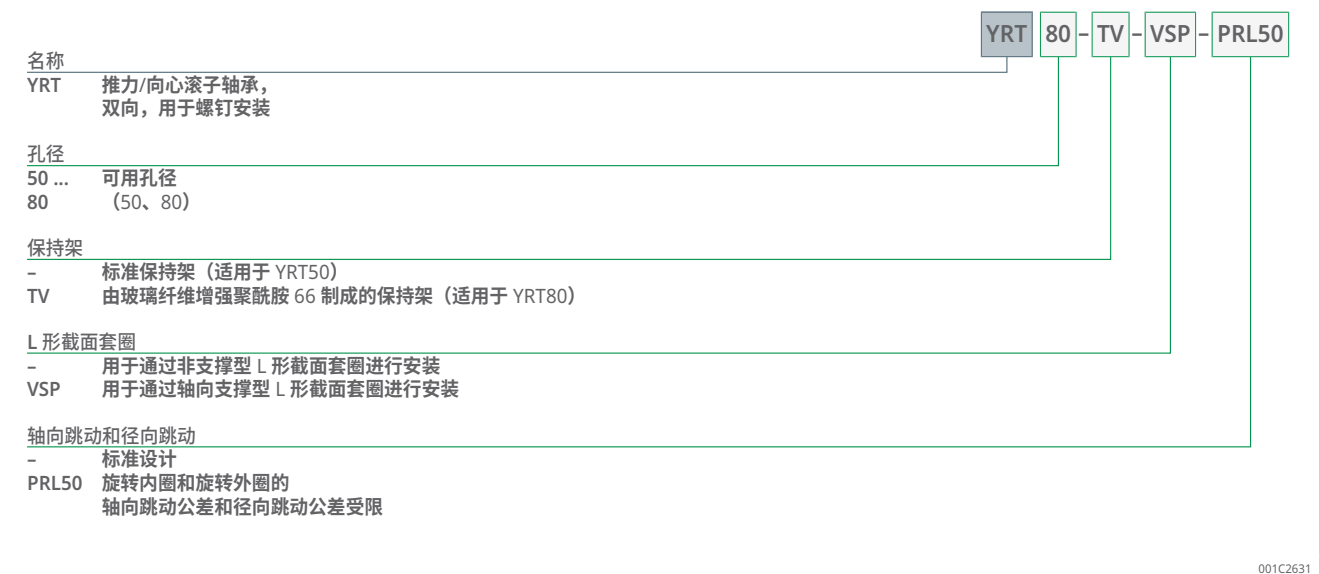
12 YRT 系列推力/向心轴承订货型号的组成结构
