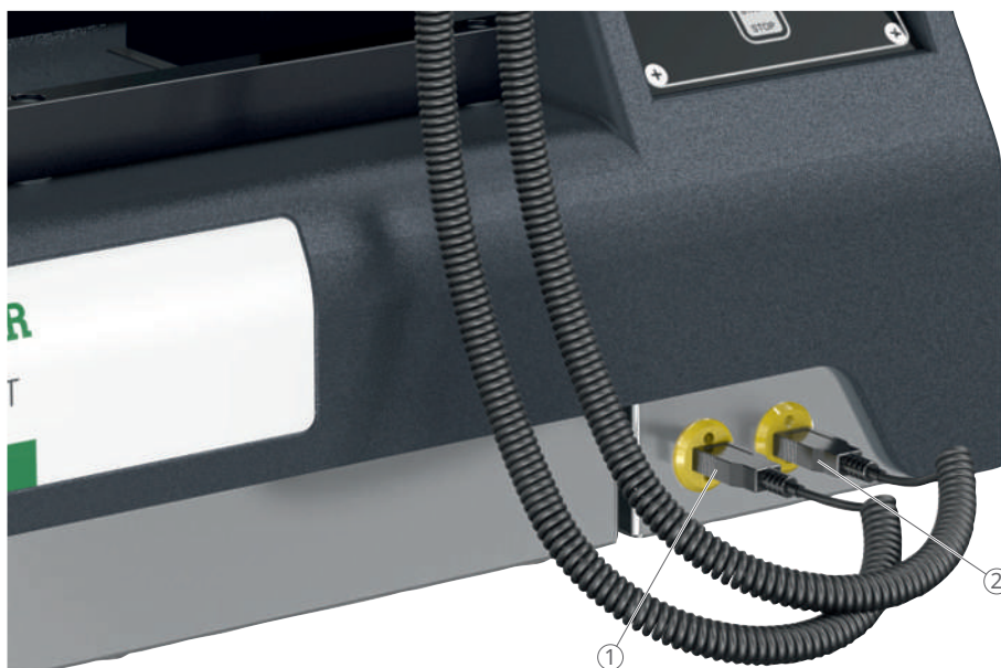
3 Aansluitingen voor de temperatuursensoren
