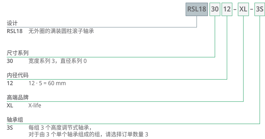
8 订货名称的组成结构，圆柱滚子轴承 RSL18
