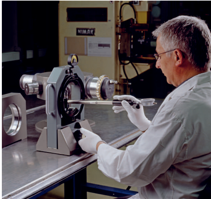
33 Laufbahndurchmesser auf das Hüllkreismessgerät übertragen
