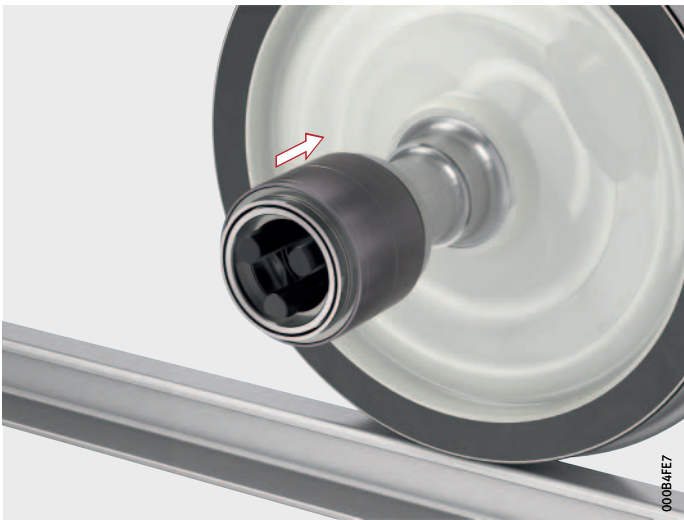
Figure 2 Pousser l'unité TAROL sur la douille de guidage
