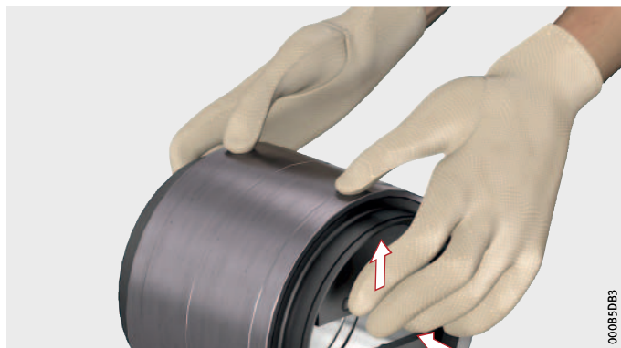
Figure 10 Insérer les segments d'extraction
