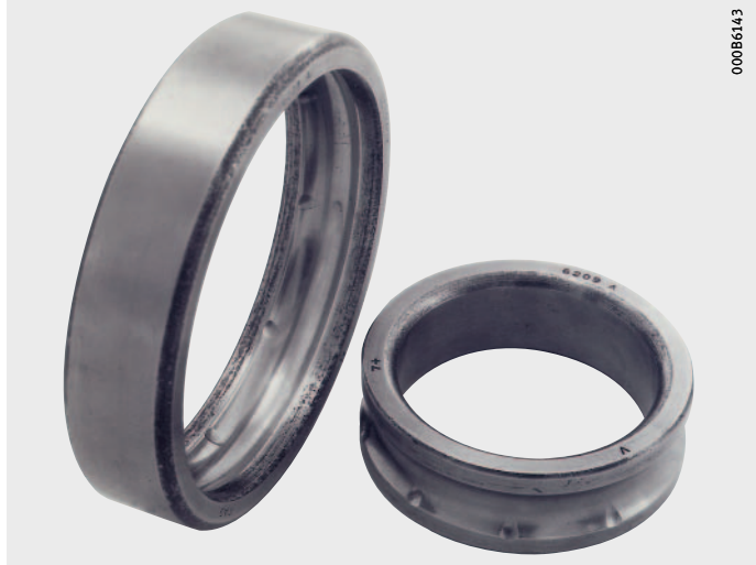
Figure 2 Empreintes des éléments roulants (Brinelling)
