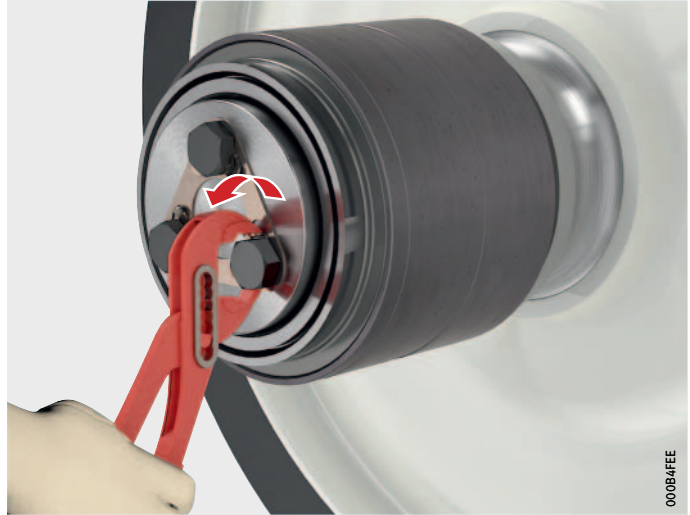
Figure 10 Plier les languettes des plaques d'arrêt
