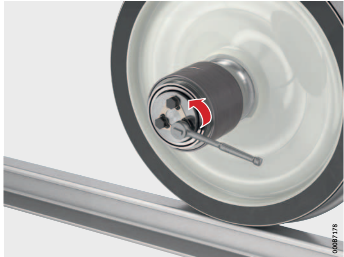
Figure 1 Démonter l'embout
