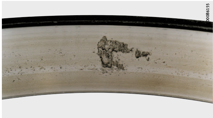
Figure 3 Dommages dus à la fatigue
