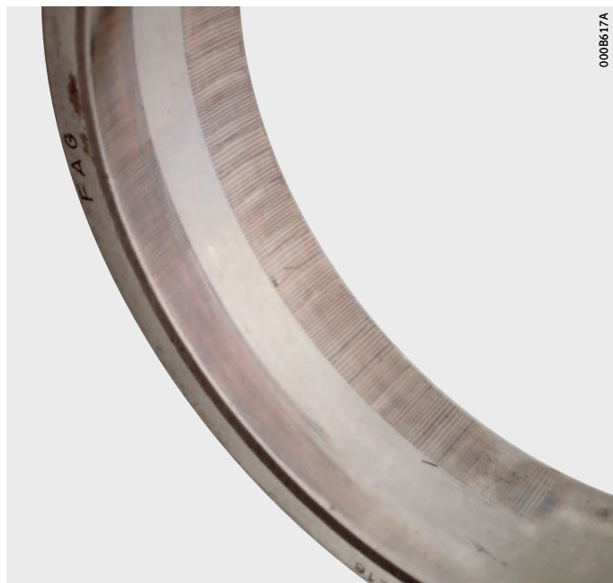
Figure 5 Dommages dus au passage de courant
