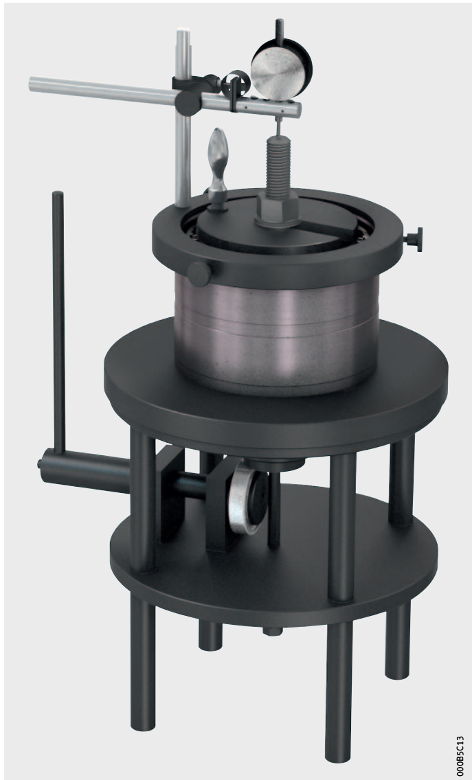
Figure 11 Anneau d'appui avec comparateur
