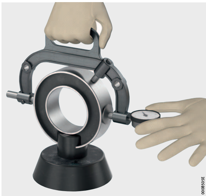
Figure 10 Réglage du micromètre extérieur sur la bague-étalon
