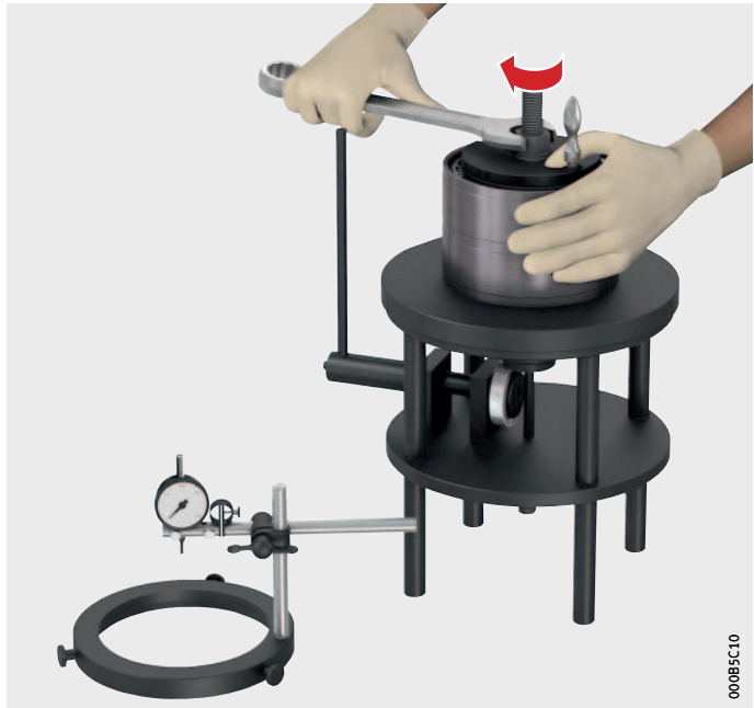
Figure 9 Serrer l'écrou à l'aide de la clé
