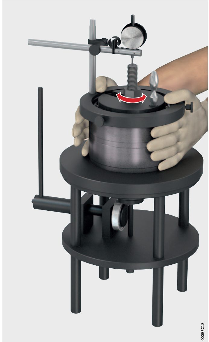
Figure 12 Tourner la bague extérieure
