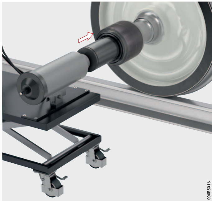
Figure 5 Ajuster le dispositif hydraulique sur l'unité TAROL
