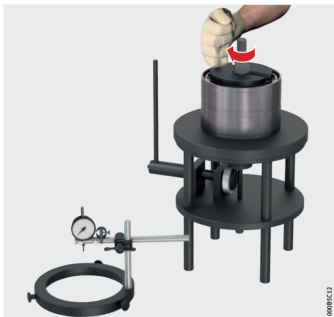
Figure 10 Tourner la bague extérieure
