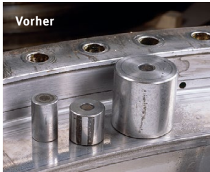
Rollen und Laufbahn mit Korrosionsspuren und Fremdkörpereindrücken
