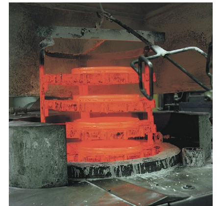
Erhöhung der Verschleiß- und Dauerfestigkeit durch Einsatzhärten
