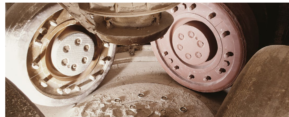
Mahlwalzen einer Vertikalmühle (Zementverarbeitung)
