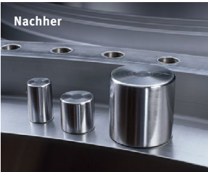
Nachgeschliffene Laufbahn, neue Rollen mit angepasstem Übermaß
