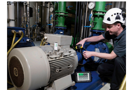
Industrie : grâce à la technologie laser unique, le LASER-EQUILIGN2 garantit en permanence un alignement professionnel de vos machines
