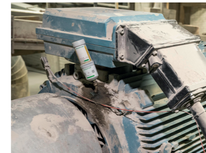
Ciment : OPTIME C1 lubrifie avec une précision extrême et, grâce à sa technologie intelligente, indique toujours l'état sur un appareil (mobile) quel que soit l'endroit
