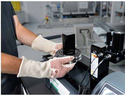
Industrie : grâce à un chauffage inductif contrôlé, les HEATERS préviennent les dommages tels que les irrégularités de fonctionnement, les fissures ou les traces d'usure
