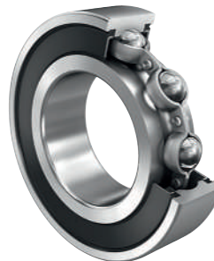
3 Beidseitig berührende Dichtungen, FD-Ausführung
