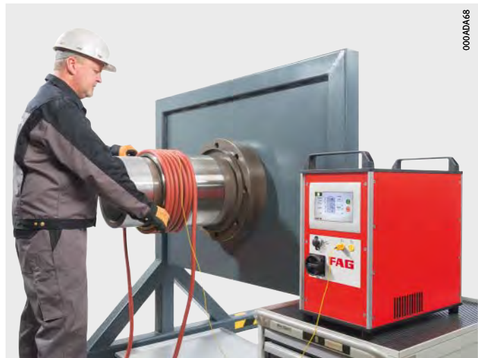
Bild 5 Demontage von Lagerinnenringen mit flexiblem Induktor
