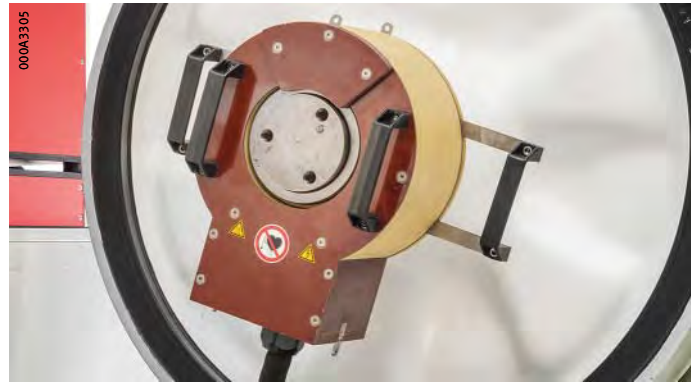
Bild 6 Demontage Lagerinnenringe von Radsatzlagern (Schienen- fahrzeuge) mit Festinduktor
