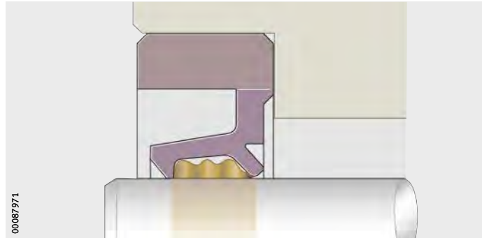
Bild 6 Fettfüllung zwischen Dicht- und Schutzlippe
