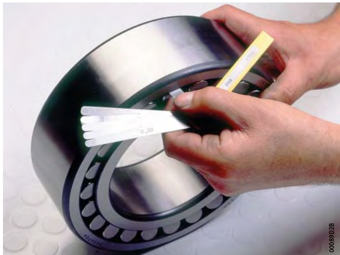
Bild 7 Messen der Radialluft mit Fühlerlehren
