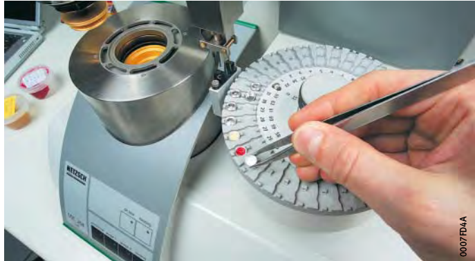
Bild 5 Analyse zum Temperaturverhalten von Fetten
