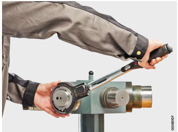
Bild 11 Montage mittels Doppelhakenschlüssel
