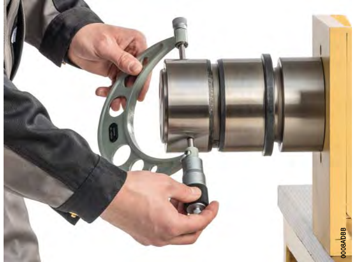
Bild 3 Aufweitung mit Außenmikrometer messen
