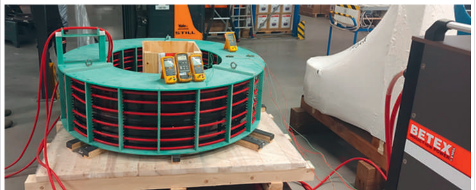
☞ 35 Twin-Induktor über dem zu erwärmenden Pendelrollenlager
