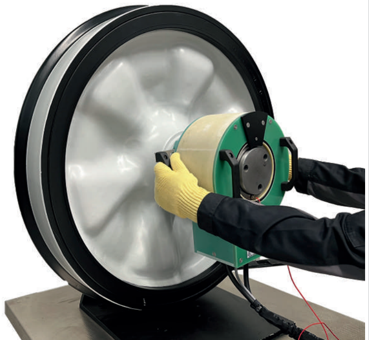
43 Demontage der Lagerinnenringe
