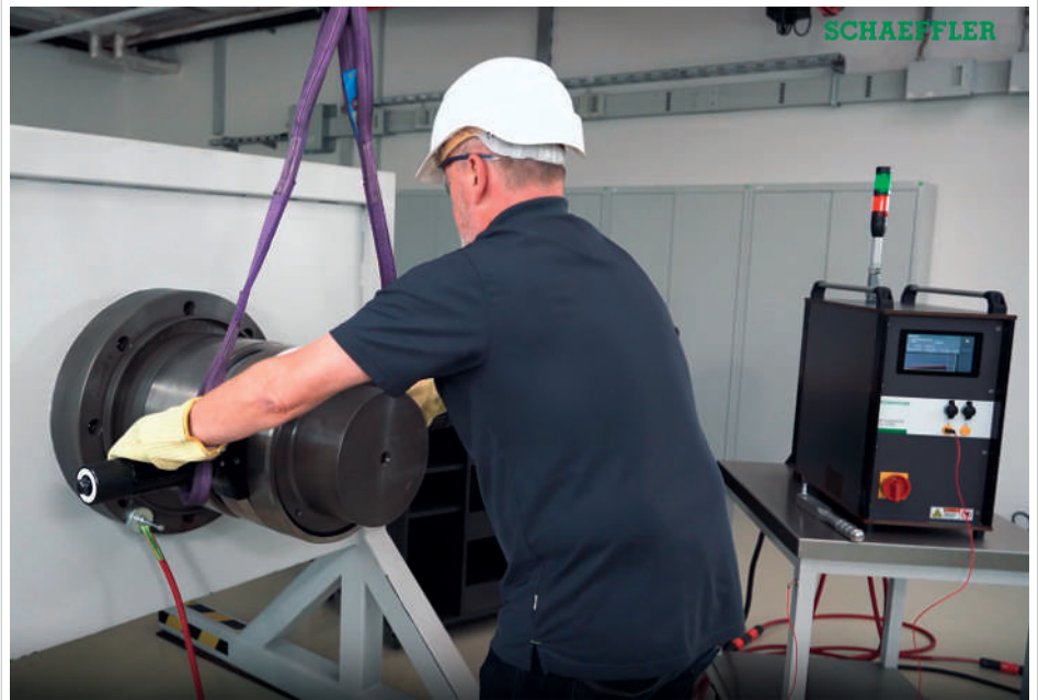
39 Transport des Lagerinnenrings mit dem Transportwerkzeug und Demontagewerkzeug BEARING-MATE
