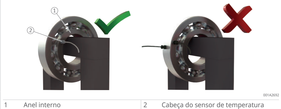
43 Colocar o sensor de temperatura T1
