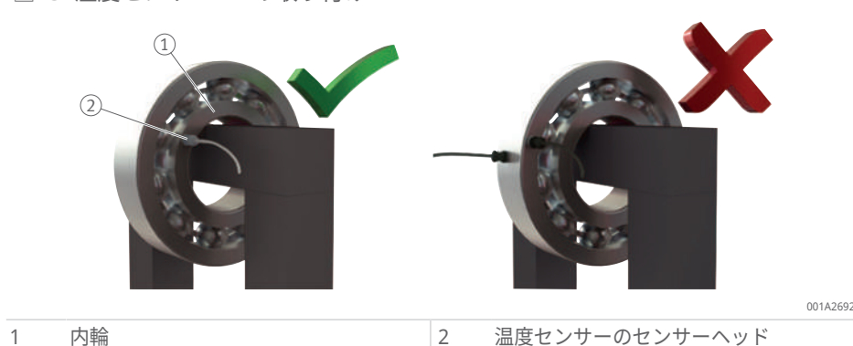
④43 温度センサー T1 の取り付け
