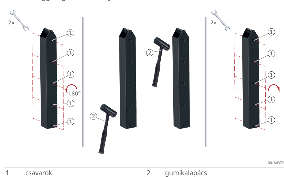
62 A függőleges keresztfej beállítása
