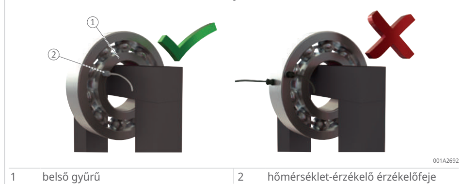
43 A T1 hőmérséklet-érzékelő felhelyezése
