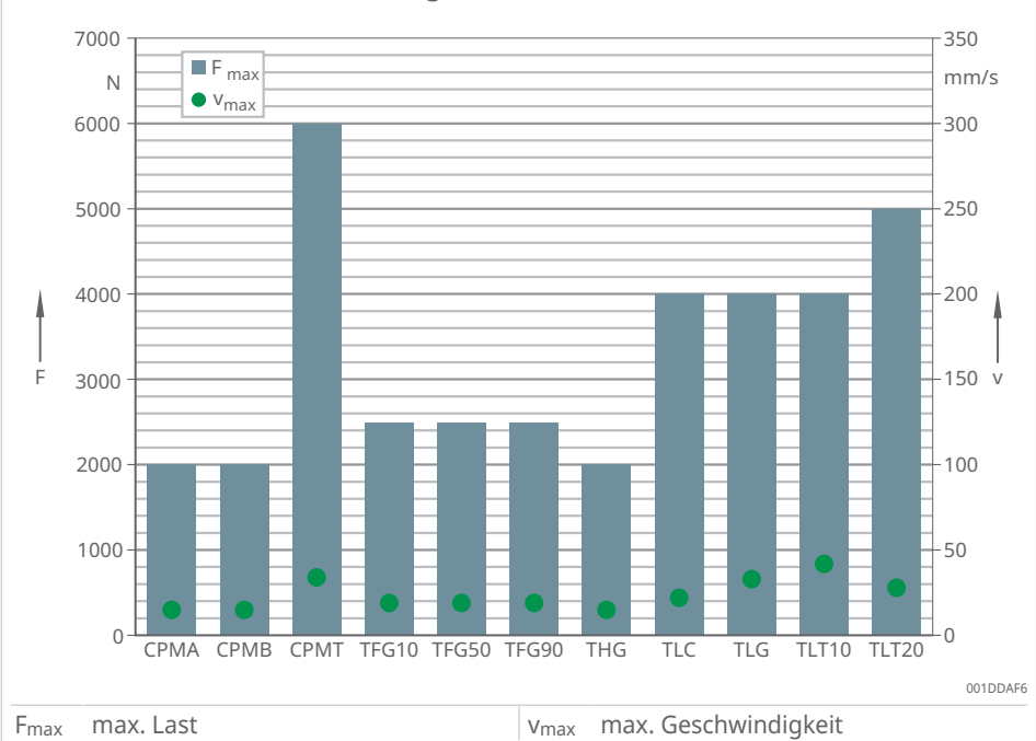
32 Nennlast und Geschwindigkeit Hubsäule
