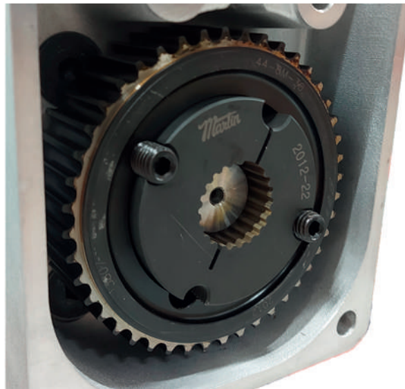
☞ 26 Riemenscheibe und Taper-Buchse auf der Lineareinheit
