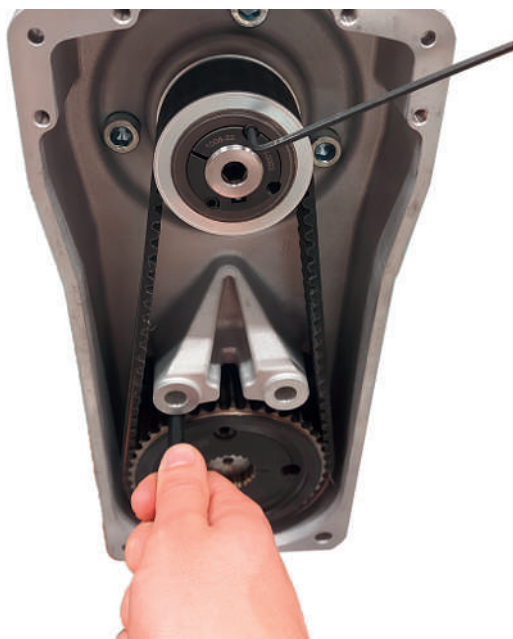
☞35 Sicherungswerkzeug für die Riemenscheibe
