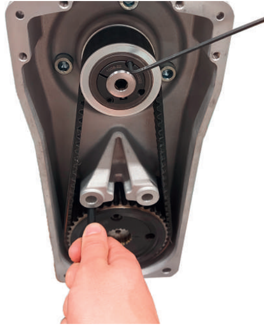
35 Sicherungswerkzeug für die Riemenscheibe
