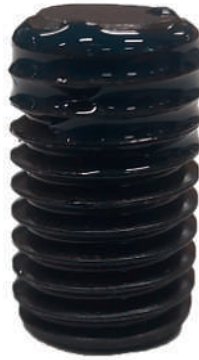
☞ 25 Loctite 243 auf Stellschraube
