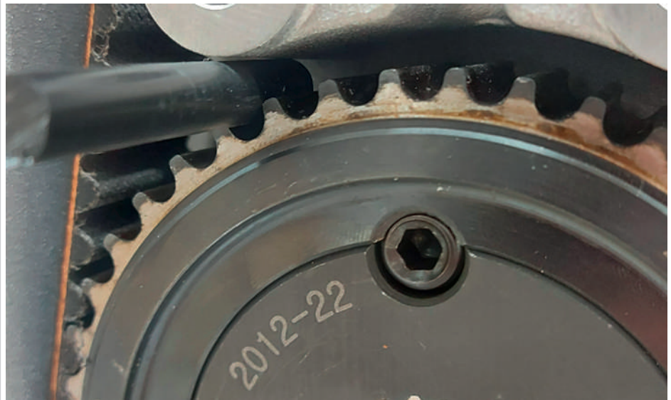
☞ 27 Sicherungswerkzeug für die Riemenscheibe
