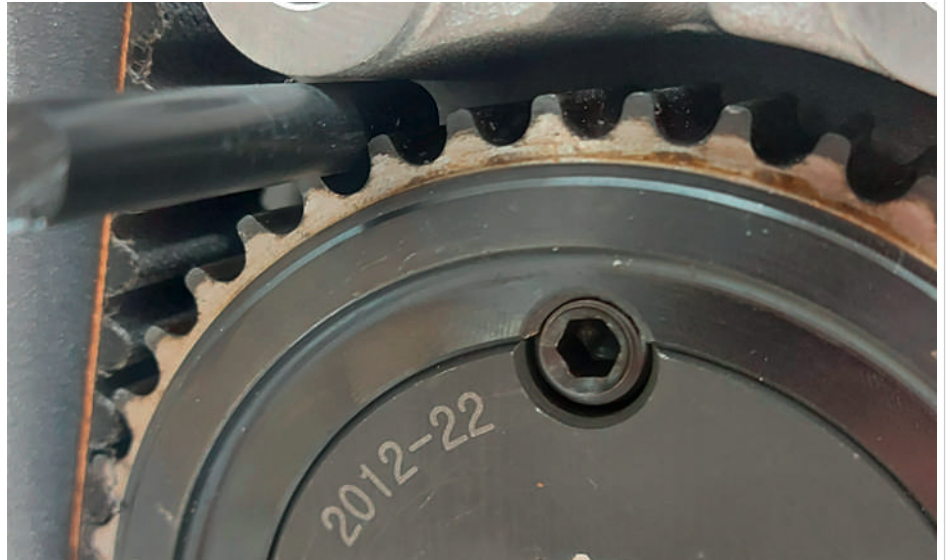
27 Sicherungswerkzeug für die Riemenscheibe
