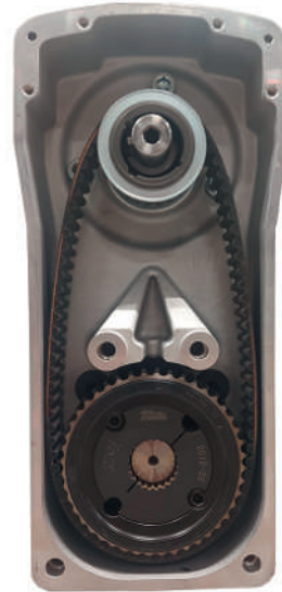
☞ 33 Riemen um beide Riemenscheiben mit Taper-Buchse
