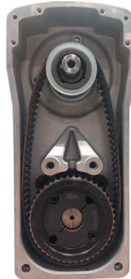
33 Riemen um beide Riemenscheiben mit Taper-Buchse
