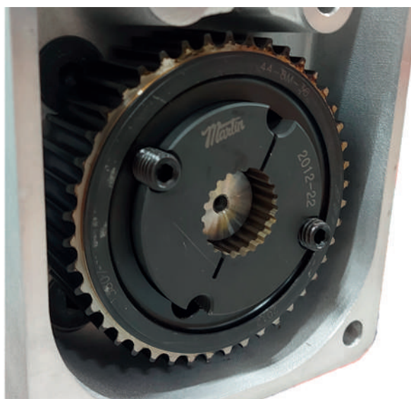
26 Riemenscheibe und Taper-Buchse auf der Lineareinheit
