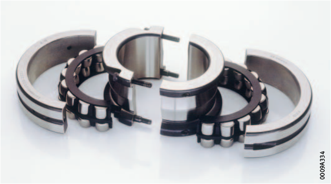
图 9 带有由玻璃纤维增强聚酰胺或黄铜制成的剖分式实体保持架和一体式锁紧环的剖分式调心滚子轴承
