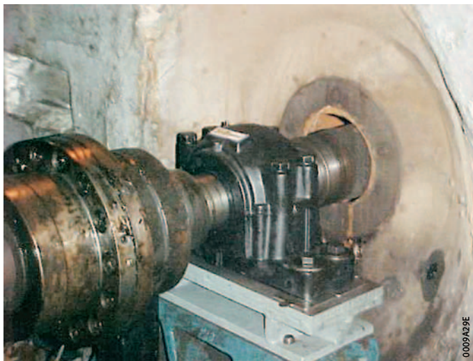
图 6 风扇和通风机中的轴承布置
