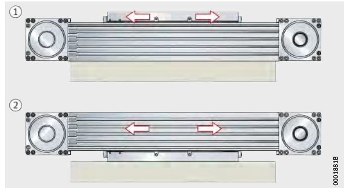
Bild 2 Laufwagen beweglich oder feststehend
