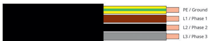
図 32 3 相および保護接地を用いた主電源の接続
