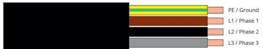
图 20 通过 3 根相线和一根保护接地线连接主电源
